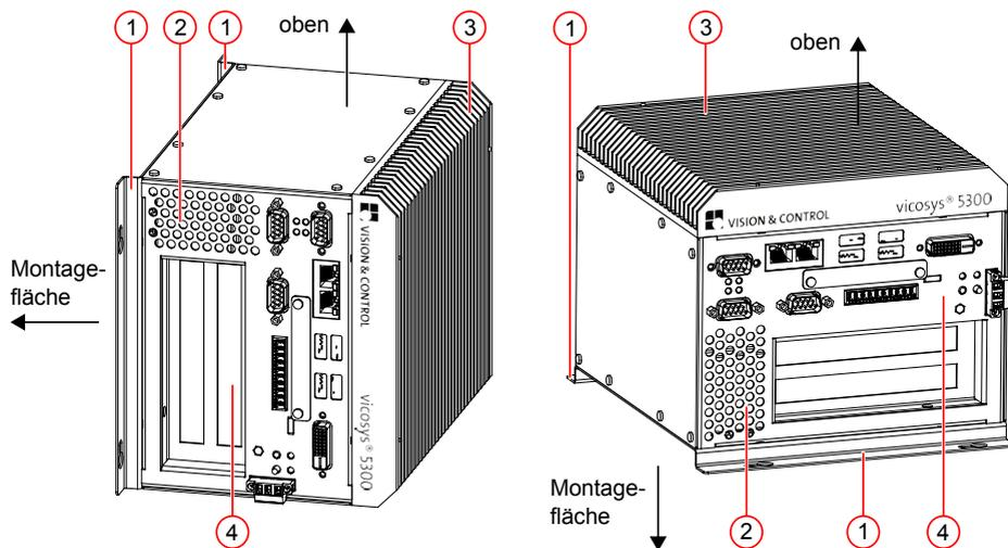
Das Gerät an den Montageschienen (1) an einer geeigneten Montagefläche verschrauben.
