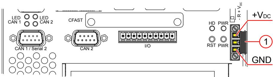
Abb. 22: Betriebsspannungsstecker
