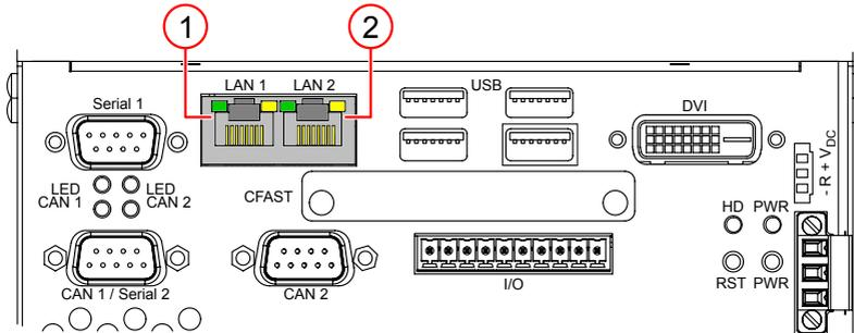
Abb. 6: Ethernet-Schnittstellen
