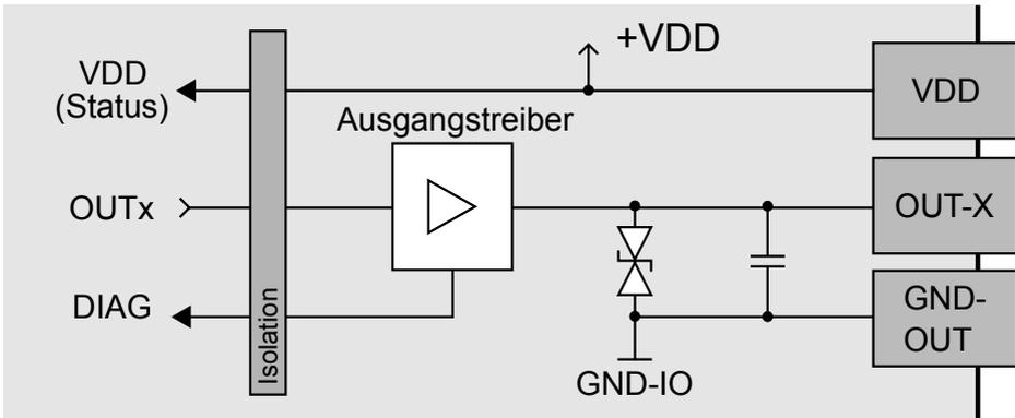
Abb. 16: Schematischer Aufbau der digitalen Ausgangskanäle 1 bis 16
