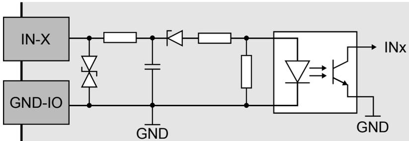
Abb. 15: Schematischer Aufbau der digitalen Eingangskanäle 1 bis 16
