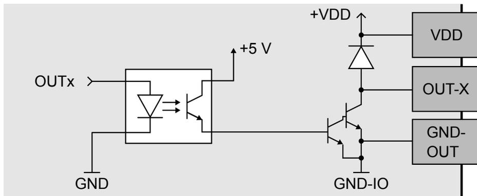
Abb. 20: Schematischer Aufbau der digitalen Ausgangskanäle
