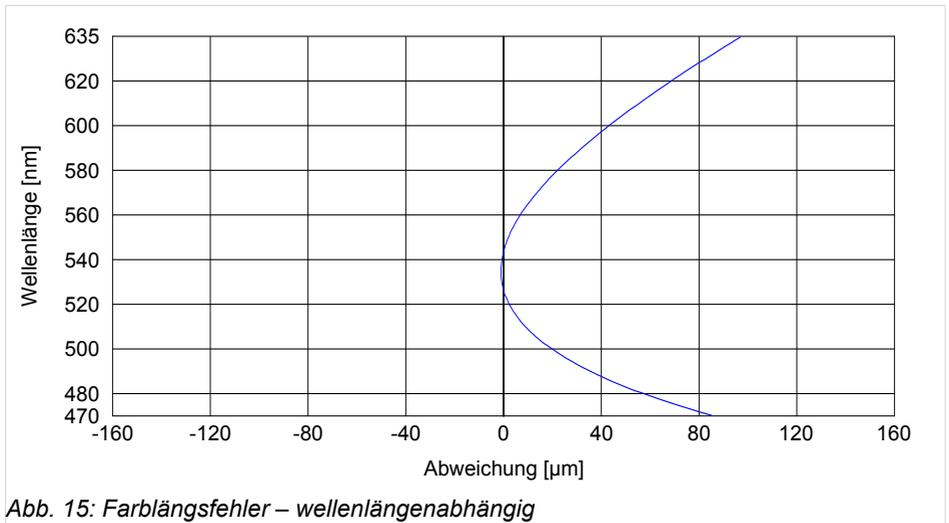
Abb. 15: Farblängsfehler – wellenlängenabhängig
