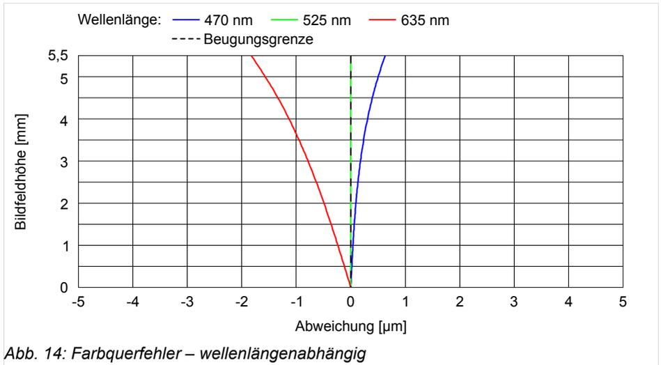
Abb. 14: Farbquerfehler – wellenlängenabhängig
