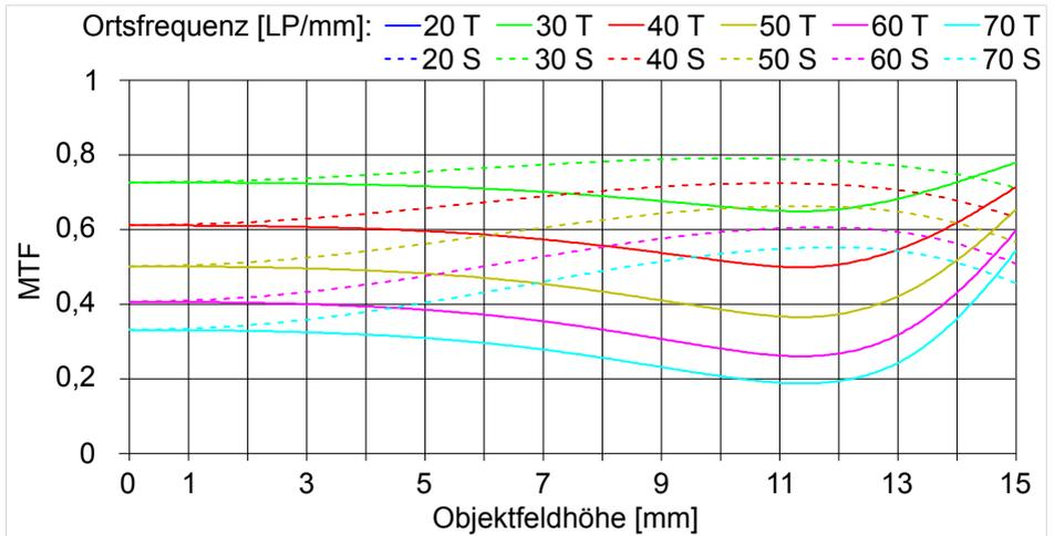
Abb. 6: MTF - objektfeldabhängig (470 nm, F10)
