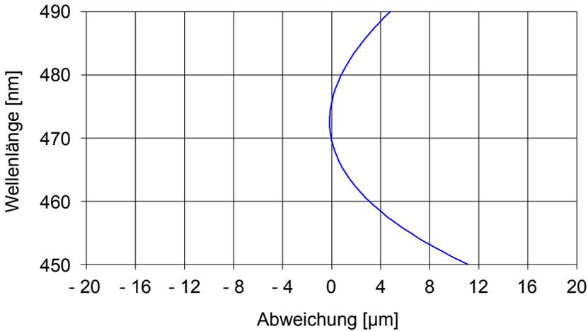
Abb. 7: Farblängsfehler – wellenlängenabhängig
