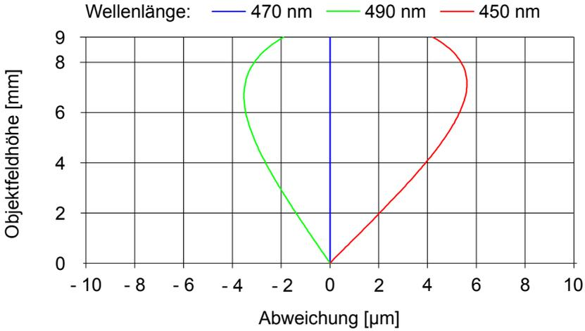
Abb. 6: Farbquerfehler – wellenlängenabhängig
